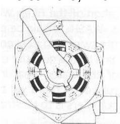
Перед выполнением операции опорожнения бассейна проверьте, что клапана скиммеров и клапана устройства очистки пола закрыты.
