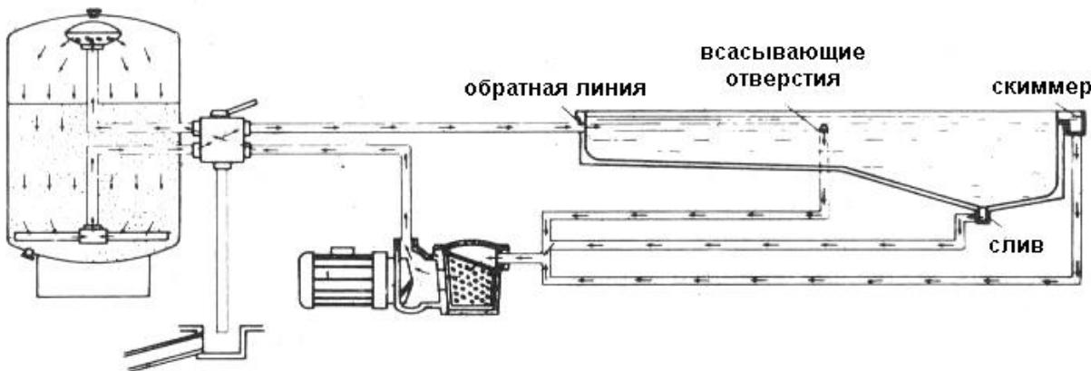
Вода всасывается из сливных отверстий, расположенных на дне бассейна и из скиммеров, установленных на уровне поверхности воды в бассейне, а затем подается поциальному трубопроводу в насос фильтра, проходит через этот насос, а затем проходит через песочный фильтр.
