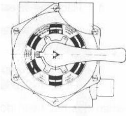
Переведите селекторный вентиль в положение "WASH" (ПРОМЫВКА), откройте всасывающие клапана в бассейне и клапана в обратной линии, и включите насос на две минуты. После выполнения данной операции, вся грязь, скопившаяся в фильтре, будет смыта.
